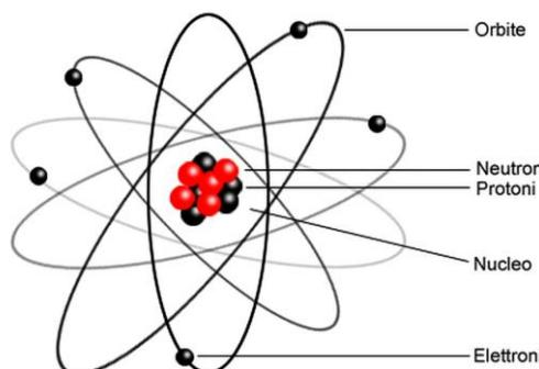
Quindi..... la corrente elettrica è un FLUSSO di elettroni che attraversa un conduttore e la capacità di questi elettroni di compiere un lavoro è detto ENERGIA ELETTRICA.
