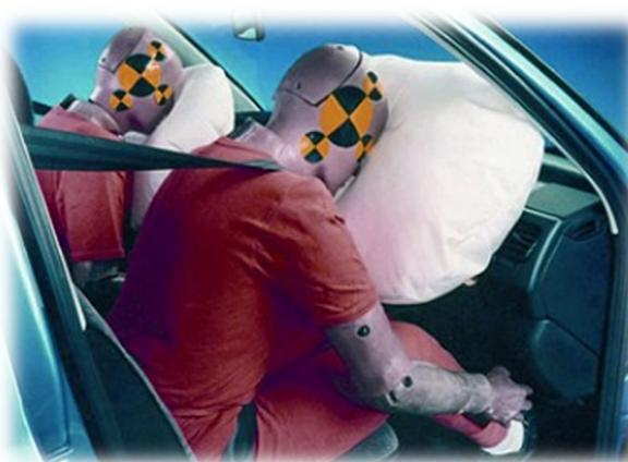
Nel rapporto  $a = \frac{\Delta V}{\Delta t}$  all'aumentare di  $\Delta t$  diminuisce **a** (la decelerazione), per cui nell'equazione  $F = m \times a$ , il valore della Forza sarà smorzato.
